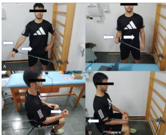
**Figura 2.** Dinamômetro Isométrico e Posicionamento do voluntário.
